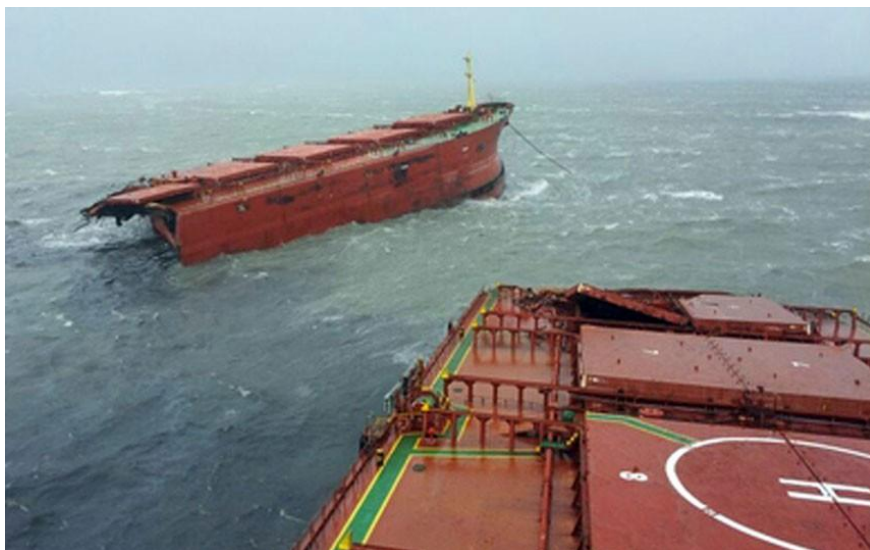
Slika 24: Pucanje brodske konstrukcije zbog zamora metala
