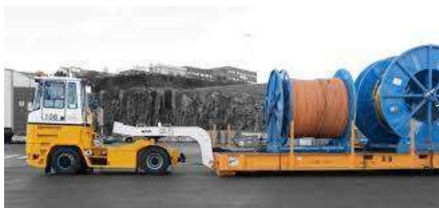
Slika 38. Prikolica kao dio brodske opreme
