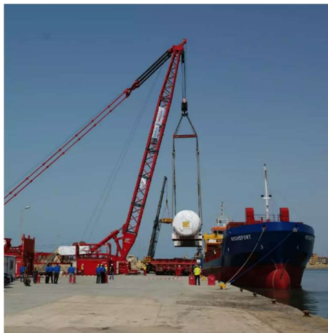
Slika 1. Podizanje generatora Izvor: Rickmers standards 4 th edition
