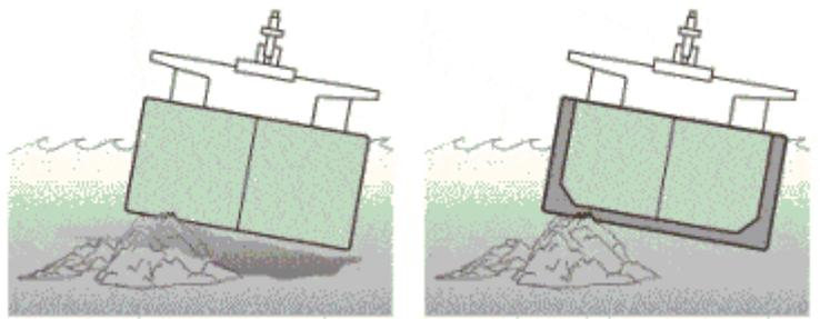
**Slika 1. Presjek broda s jednostrukom i dvostrukom oplatom**
