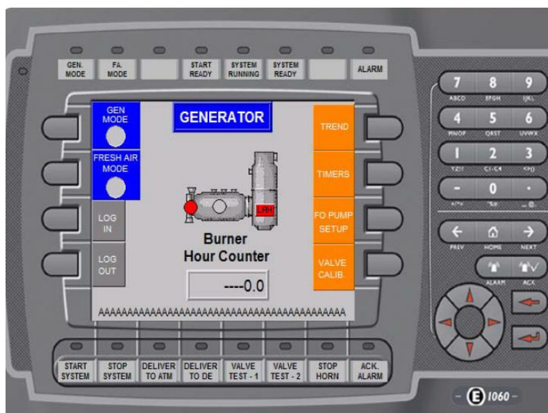
Slika 20. Osnovni prikaz na displeju za upravljanje sustavom inertnog plina tankera „Istra“
