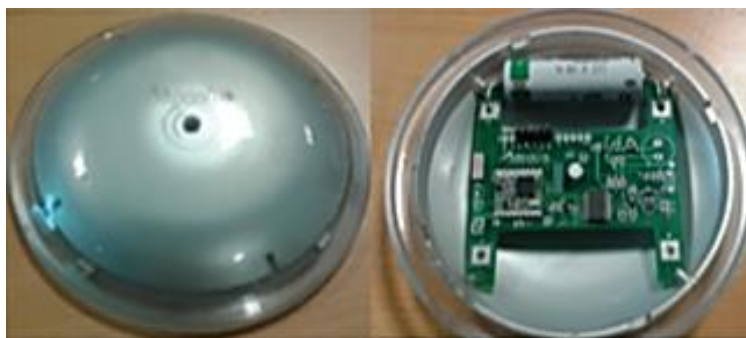
Slika 13: Bežični magnetski senzori koji se ugrađuju ispod parkirnih mjesta
