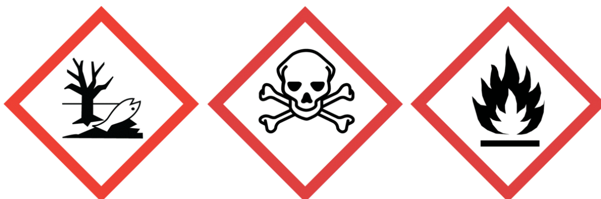
Slika 9 Oznake HNS-a za vodenu opasnost, otrovnu tvar i zapaljivi materijal
