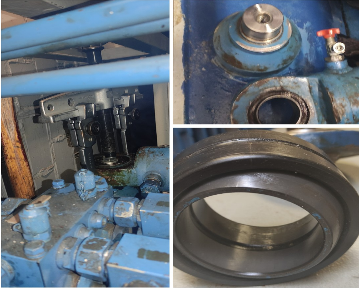
Crtež 18: Cilindar, temeljna ploča i ležaj
