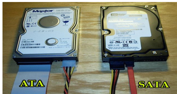
Slika 7. Usporedba veličine ata i sata konektora
