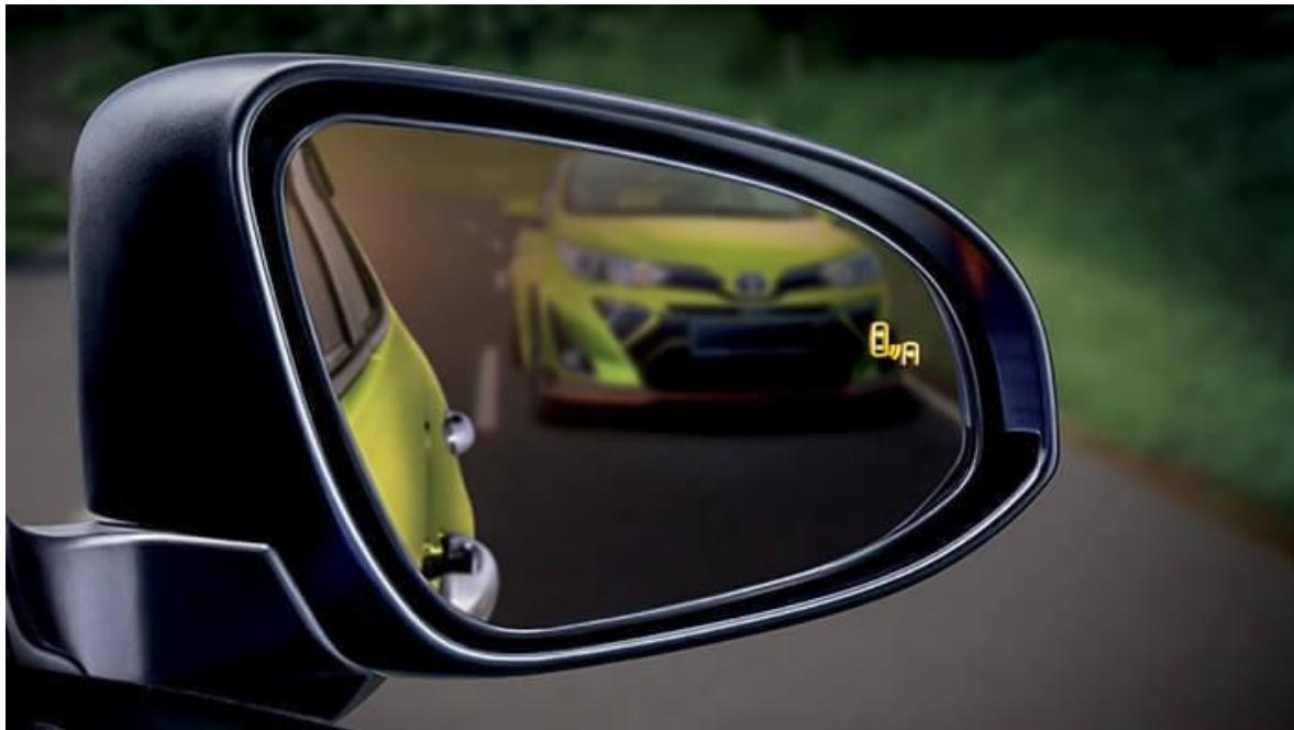
*Slika 2 Prikaz sustava za nadzor mrtvog kuta*
