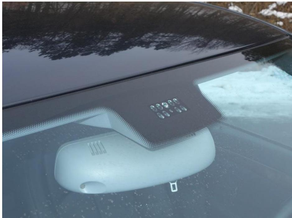
*Slika 6 Primjer senzora za kišu*
