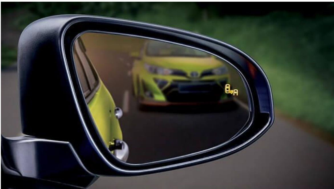
Slika 2 Prikaz sustava za nadzor mrtvog kuta
