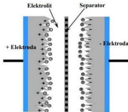
**Slika 16.** Pojednostavljena struktura superkondenzatora
