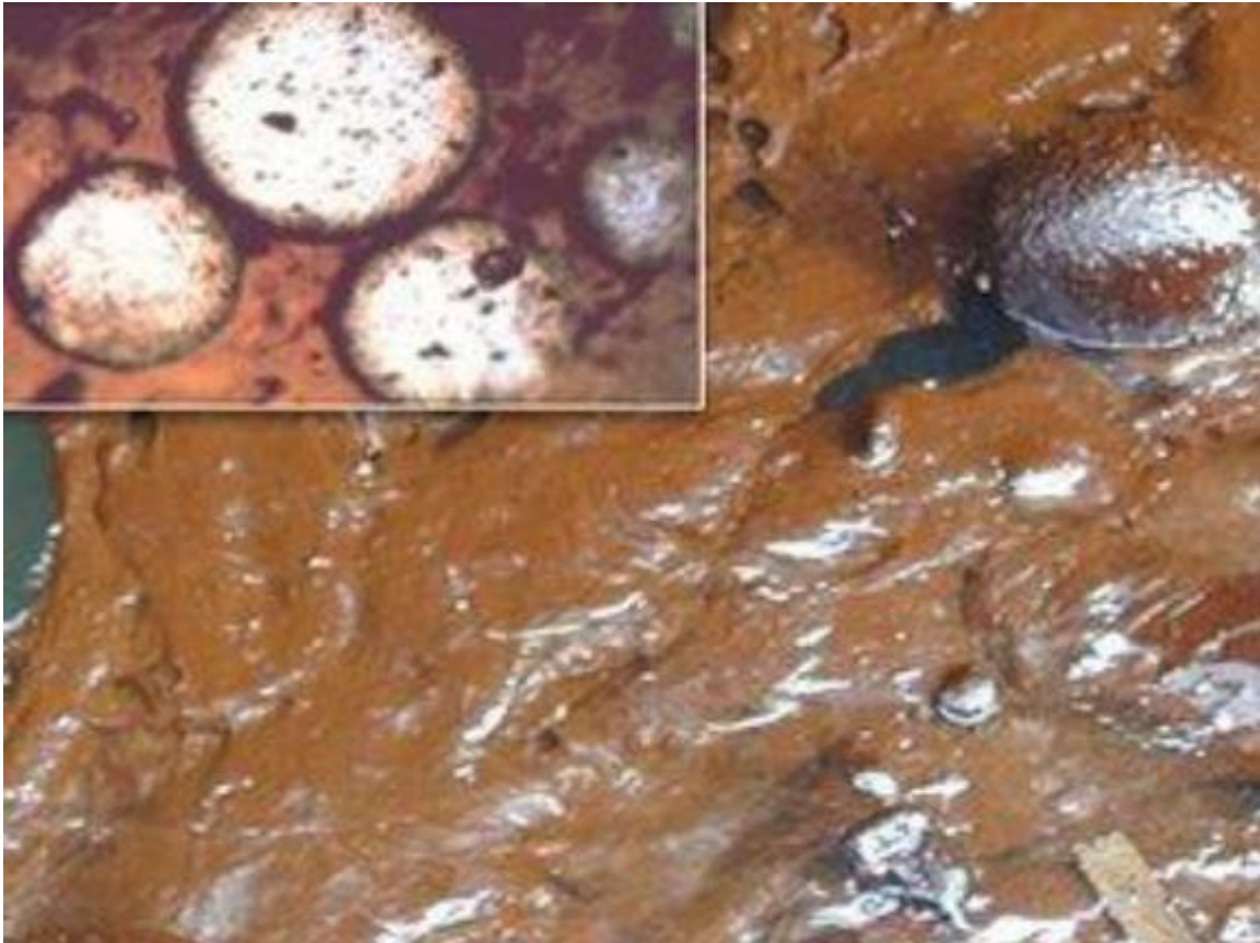
Slika 5. Prikaz emulzije vode u ulju i emulgirani mazut
