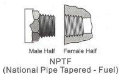
Slika 17 prikazuje muški cijevni navoj
