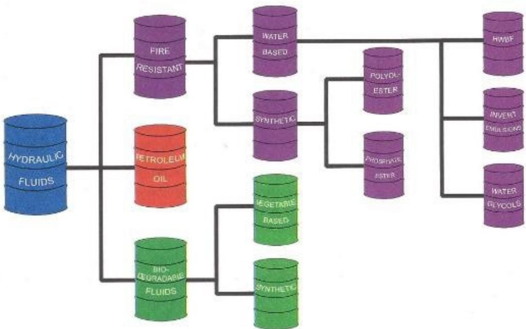
Slika 13 – tipovi fluida obično korištenih u hidrauličkim sustavima.
