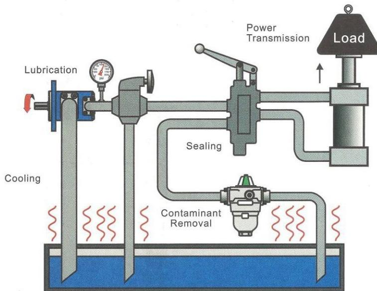
Slika 1 – prikazuje bitna svojstva fluida u hidrauličkom sustavu.
