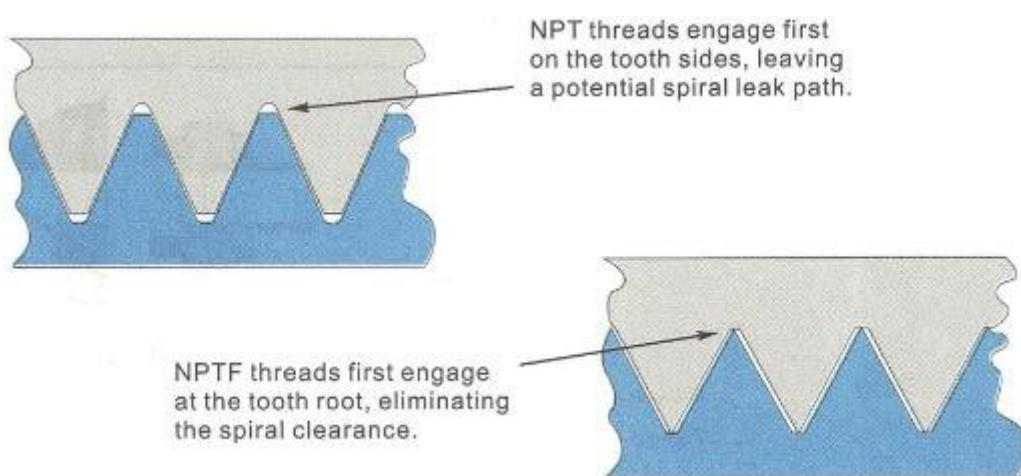
Slika 18 - prikazuje cijevni navozi koji se ne preporučuju za hidrauličke sustave — međutim, ako se koriste, moraju biti NPTF
