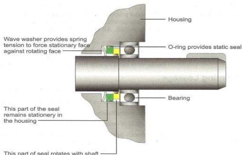
Slika 35 – prikazuje čeonu brtvu za visoki tlak brtljenja rotirajuće osovine
