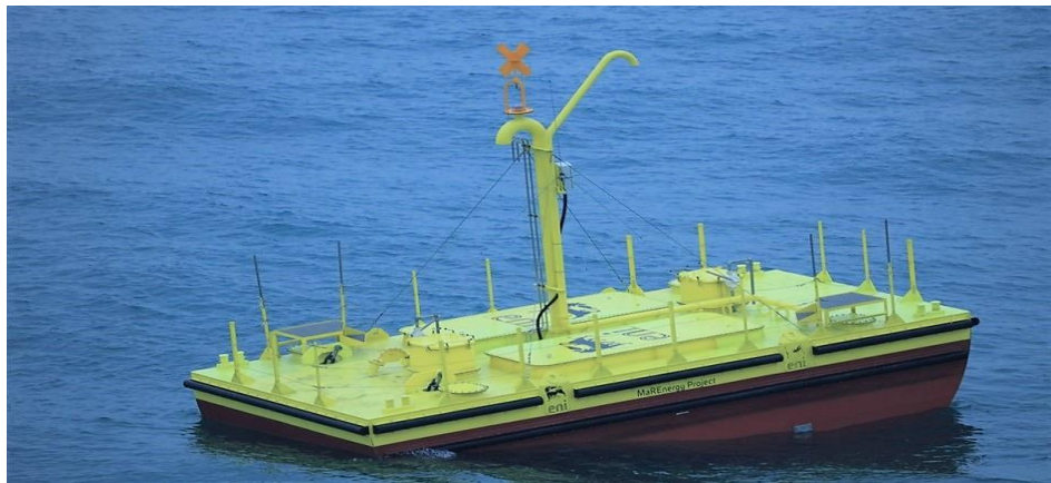
Slika 18: ISWEC uređaj postavljen u blizini obale Talijanskog otoka Pantelleria
