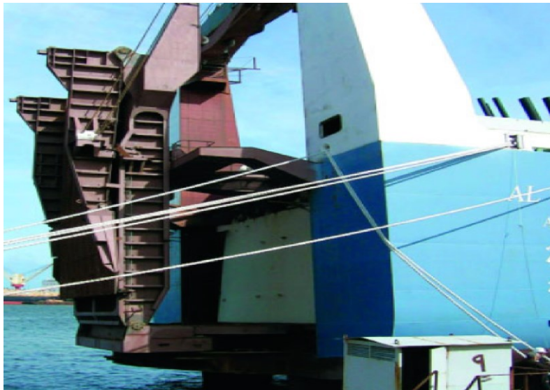
Slika 9. Krmena okretna rampa
