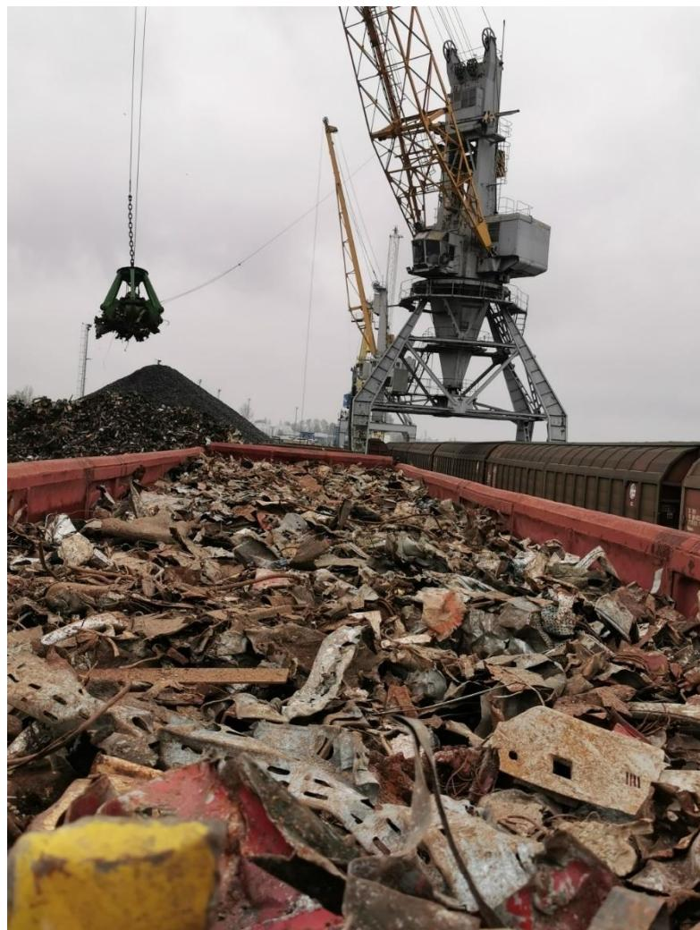
**Slika 32. Direktni istovar iz vagona na skladište**
