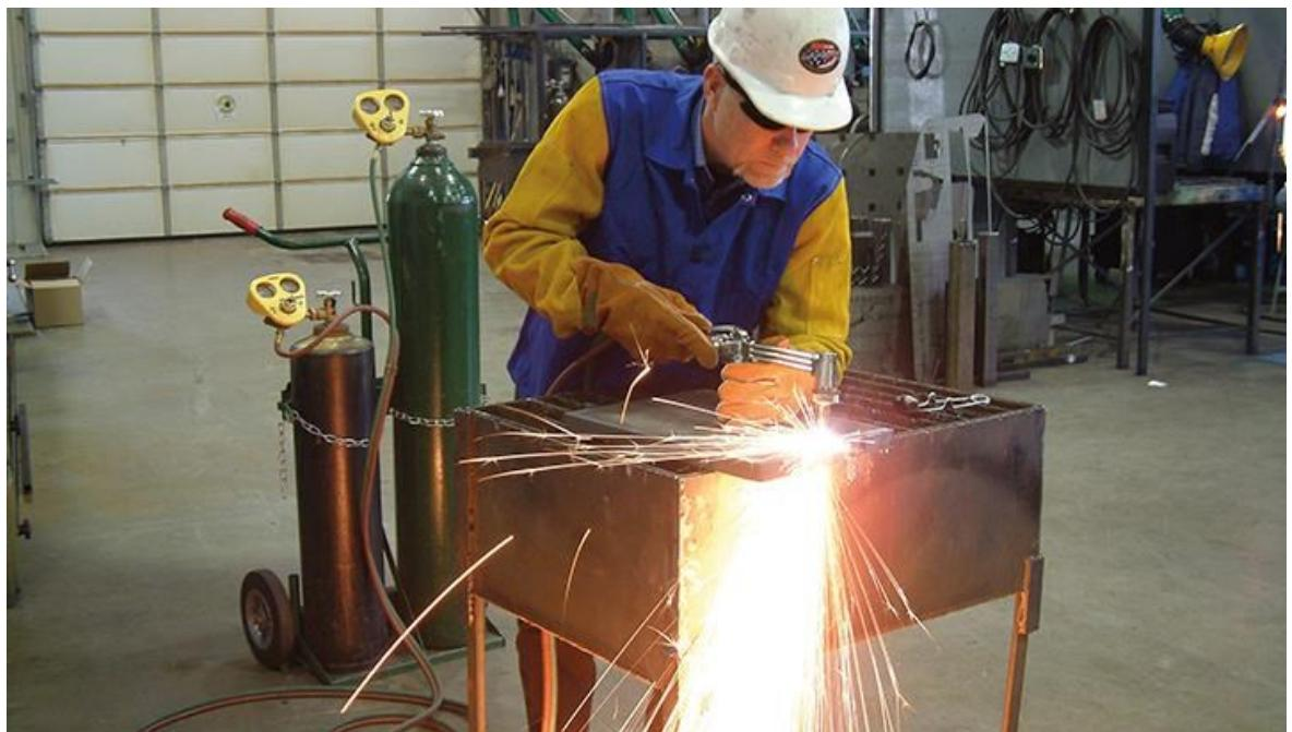
**Slika 10. Postupak plinskog ili autogenog rezanja**
