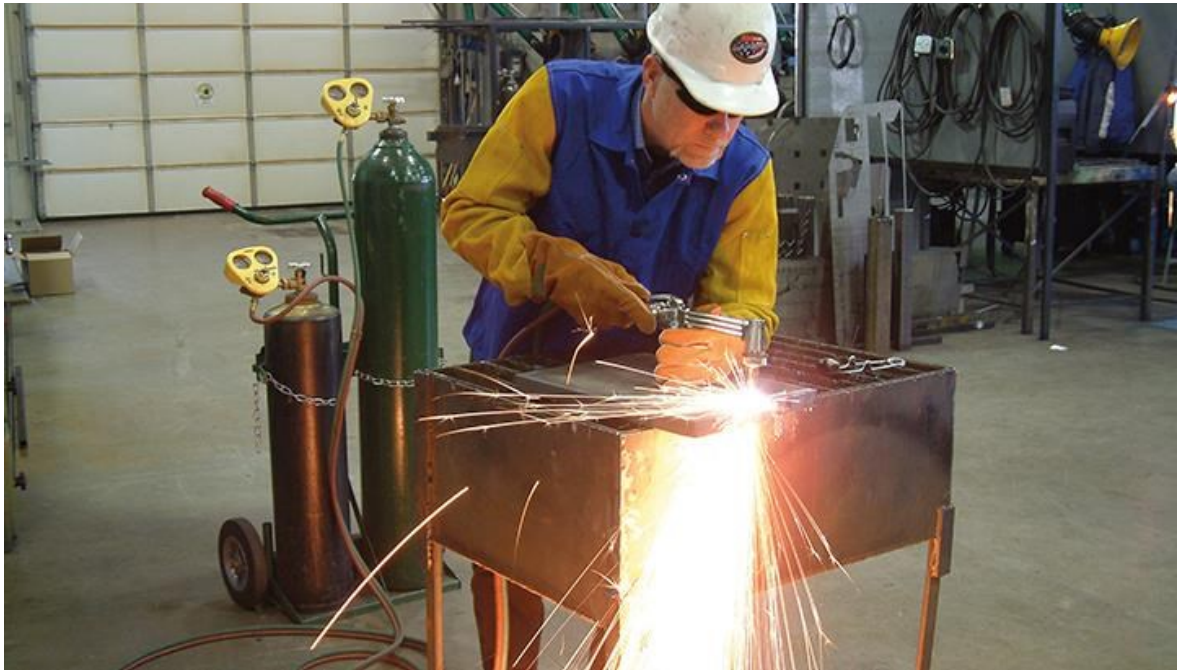
Slika 10. Postupak plinskog ili autogenog rezanja
