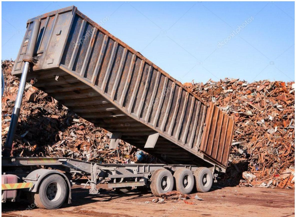
**Slika 28. Istovar tereta pomoću ugrađenog sustava hidraulike**
