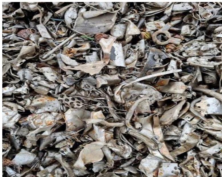
**Slika 6. Primjer otpadnog željeza kvalitete E40 – Shredded steel**
