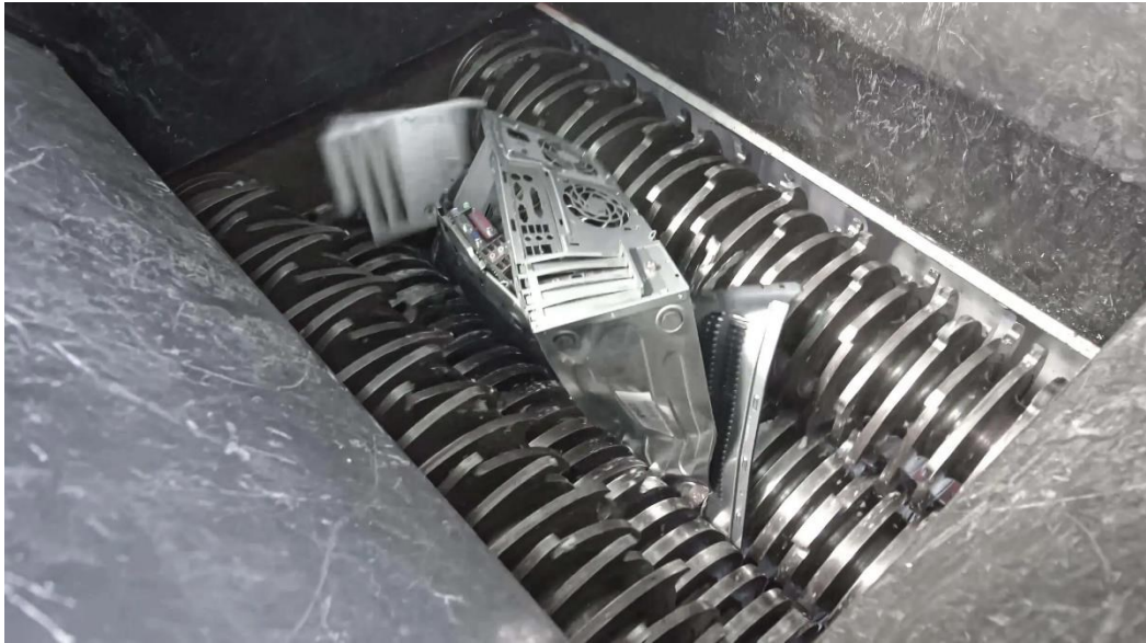
Slika 9. Ulaz u mlin gdje počinje usitnjavanje otpadnog željeza
