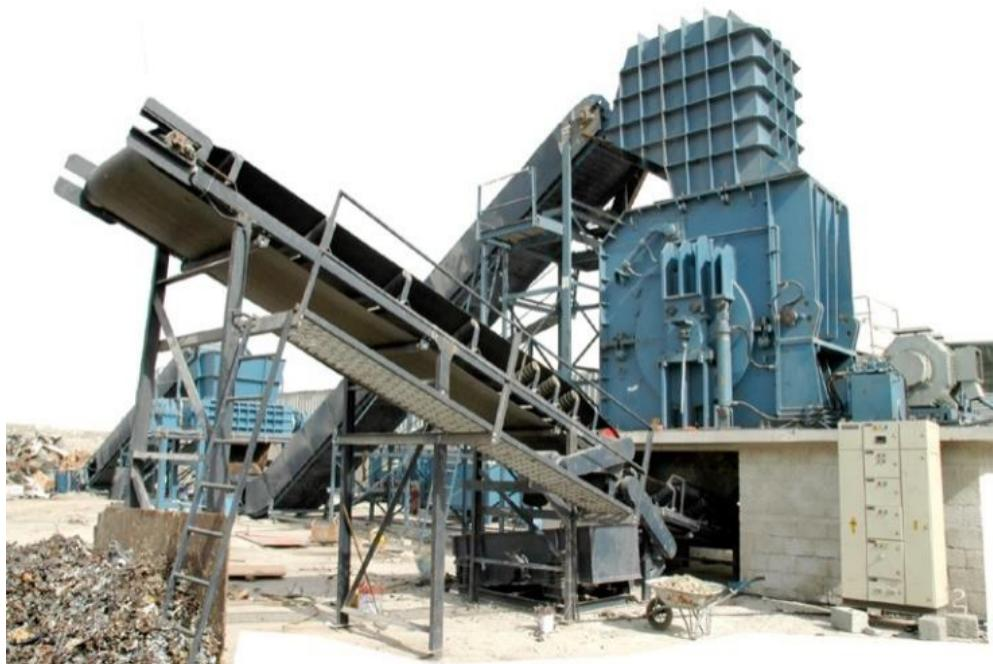
**Slika 8. Stroj kojim se radi *shredded steel***
