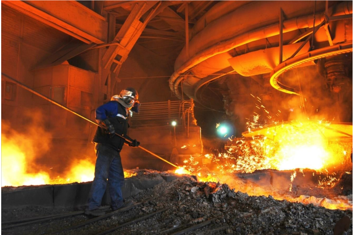
Slika 24. Taljenje otpadnog željeza
