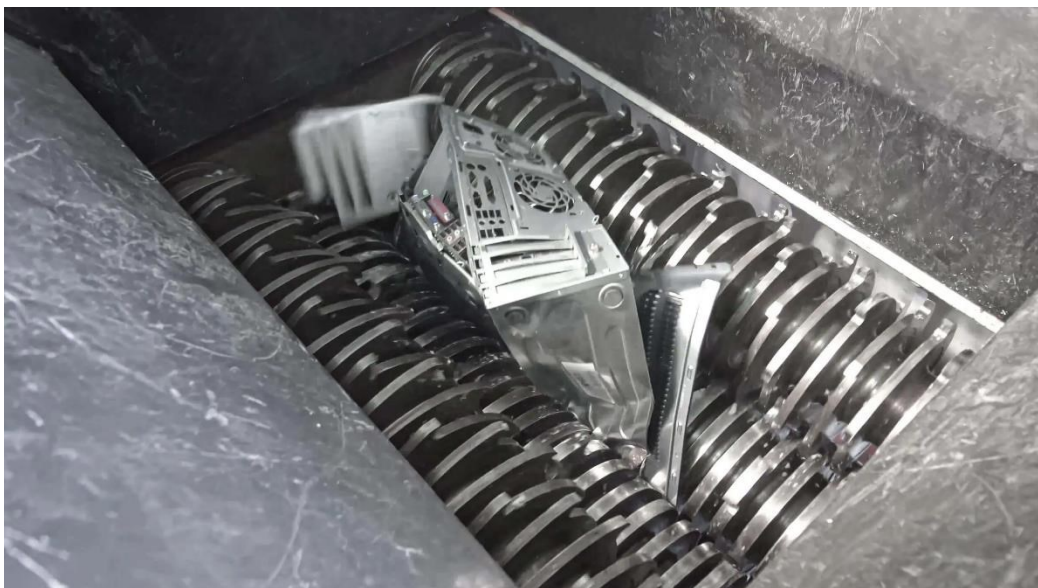
Slika 9. Ulaz u mlin gdje počinje usitnjavanje otpadnog željeza
