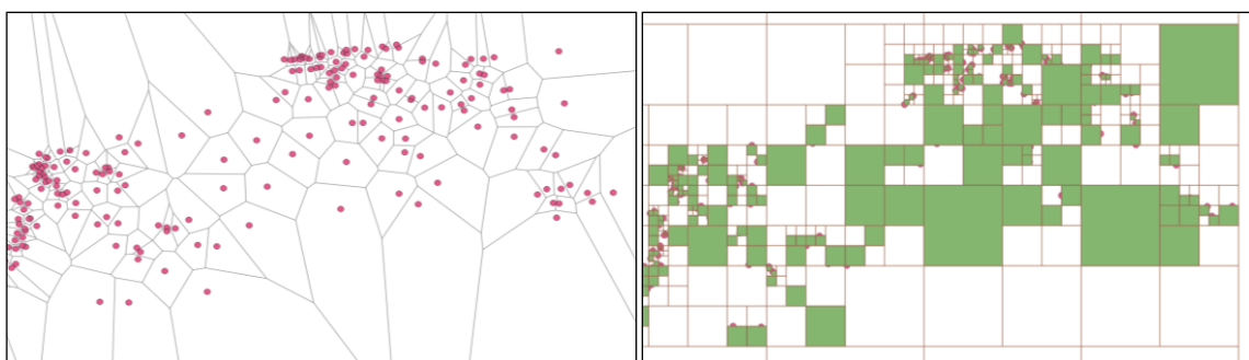
Slika 26. Diskretizacija Voronojevih dijagramima i četvornim stablima. Priredio autor
