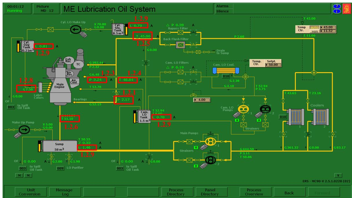
Slika 1 - Prikaz sustava ulja za podmazivanje glavnog brodskog motora [3]
