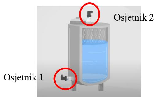
Slika 17 - Pojednostavljeni prikaz tlačnog (hidrostatskog) mjerača razine [25]
