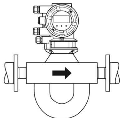
Slika 24 - Mjerač protoka na principu Coriolisovog učinka [33]
