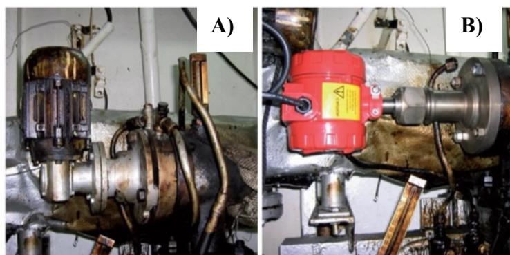
Slika 21 - Usporedni prikaz kapilarnog (A) i vibracijskog (B) viskozimetra [21]
