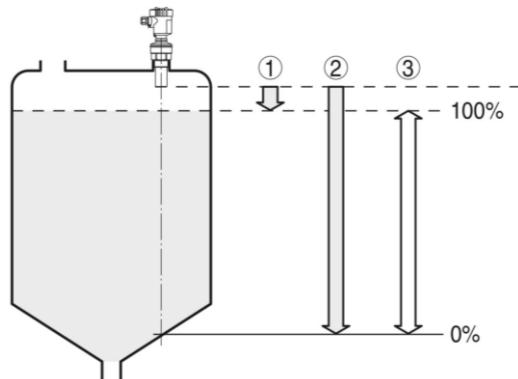
*Slika 18 - Prikaz smještaja i mjernog područja ultrazvučne sonde [27]*
