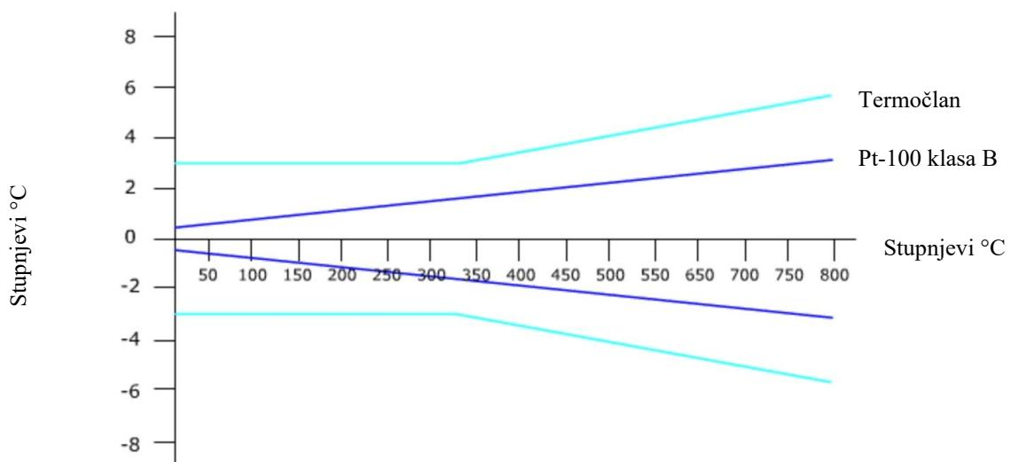
*Slika 10 - Tolerancijskog polja termočlanova u usporedbi s otrporničkim termometrom klase B [6]*
