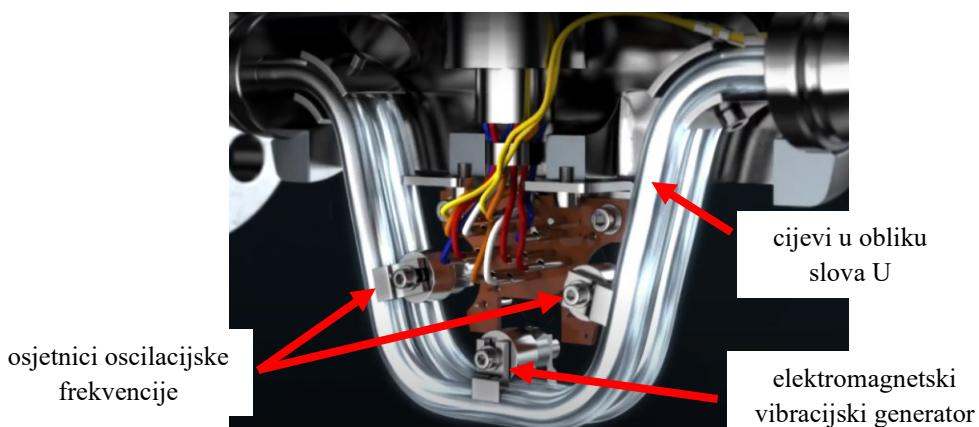
Slika 25 - Presjek mjerača protoka na principu Coriolisovog učinka [32]
