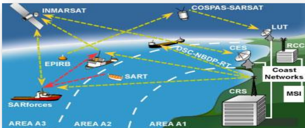
Slika 1. Shematski prikaz koncepta rada GMDSS sustava
