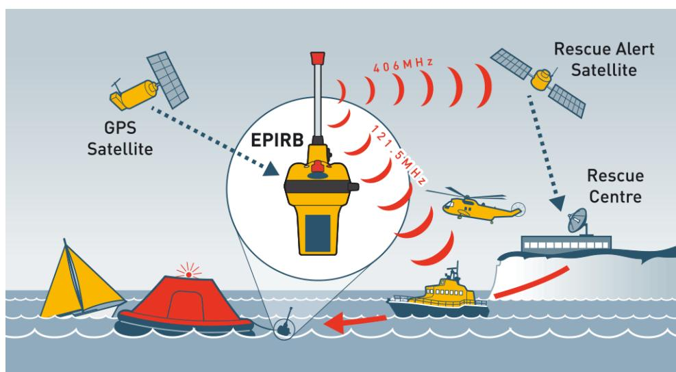
**Slika 3. Primjer rada EPIRB uređaja**
