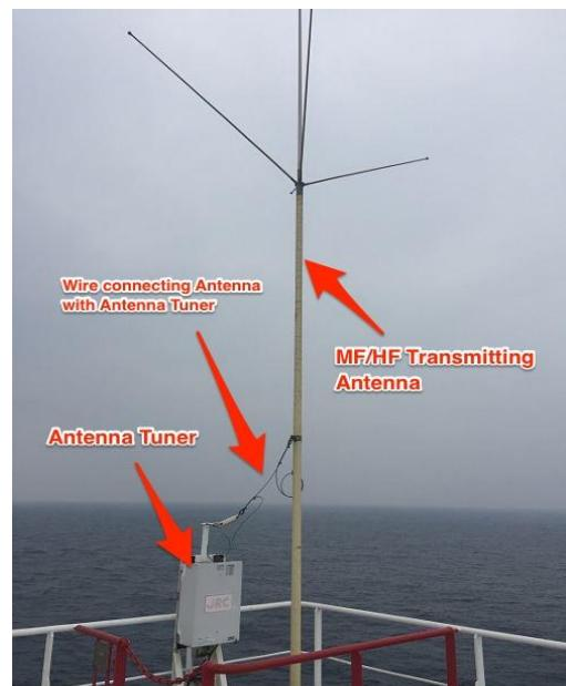
**Slika 9. MF/HF antena**
