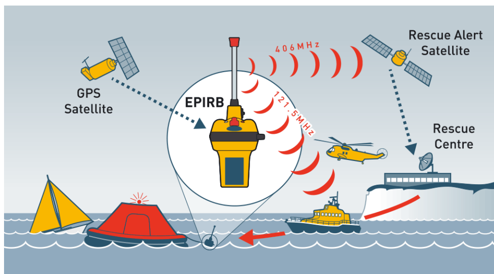
Slika 3. Primjer rada EPIRB uređaja
