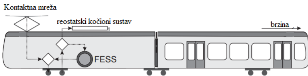
Slika 31 - Regenerativno kočenje unutar željezničkog prometa
