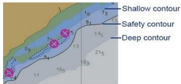
Slika 8. Primjer sigurnosne konture na ECDIS-ovu zaslonu gdje se razlikuje, tj. dijeli plitka, sigurnosna i duboka kontura (Ships Business, 2015)
