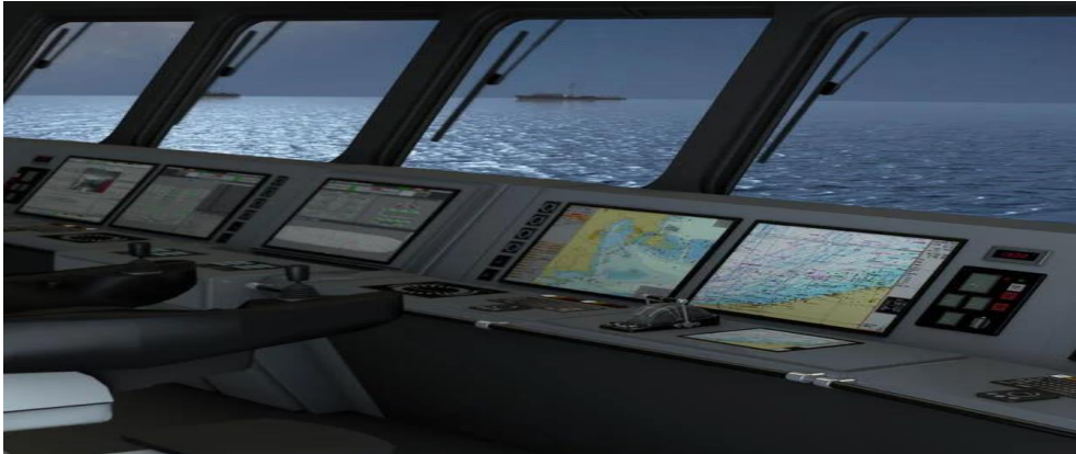
Slika 4. Smještaj ECDIS-a na mostu (L3HARRIS, 2024)
