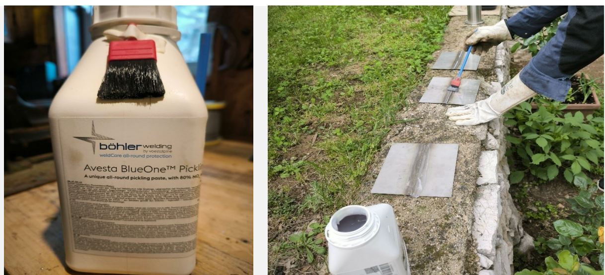
Slika 18. Kemijska zaštitna obrada pastom Avesta Izvor: Autor
