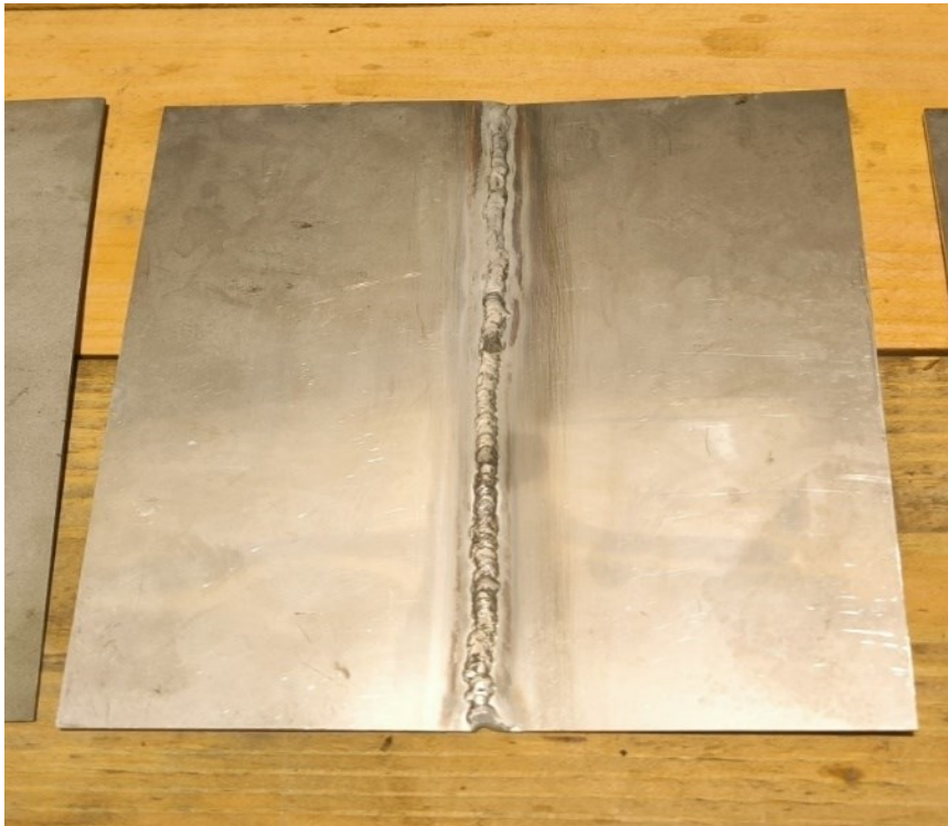
Slika 19. Prikaz lima koji je obrađen pastom Avesta Izvor: Autor
