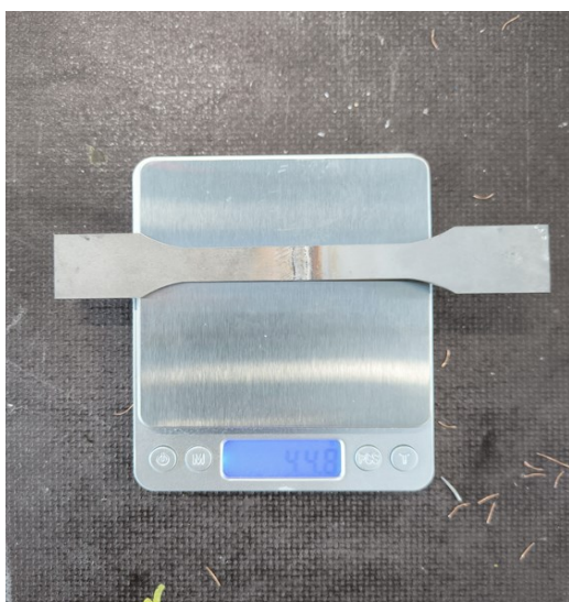
Slika 23. Mjerenje mase različitih tipova uzoraka
