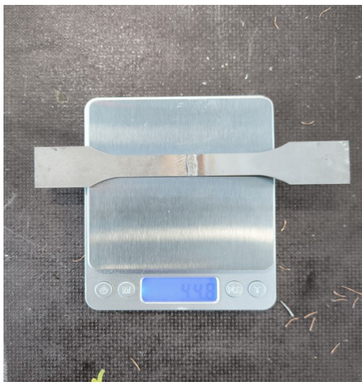
Slika 23. Mjerenje mase različitih tipova uzoraka
