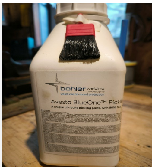
Slika 18. Kemijska zaštitna obrada pastom Avesta Izvor: Autor
