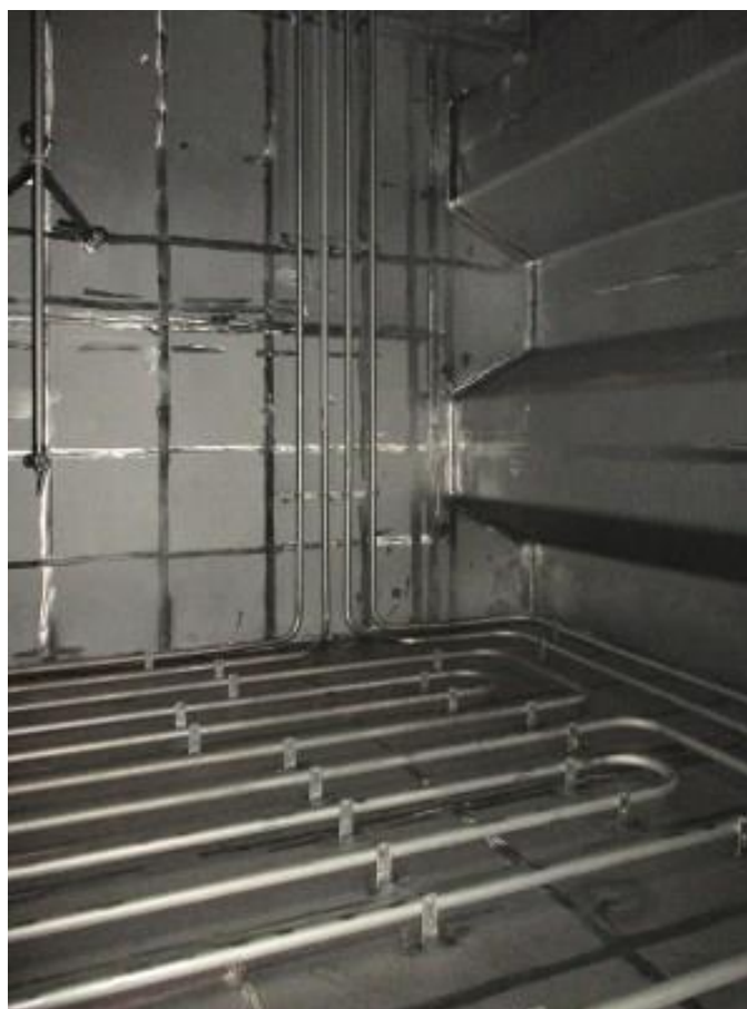
Slika 10. Sustav serpentina unutar tanka tereta
