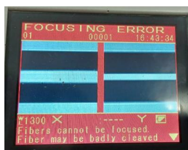
Slika 16. Greška fokusiranja zbog lošeg ruba
