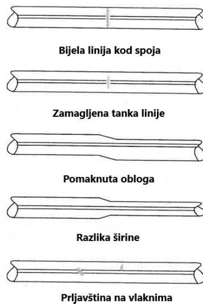
Slika 11. Mane kod spajanja optičkih vlakana
