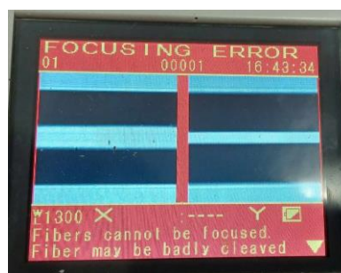
Slika 16. Greška fokusiranja zbog lošeg ruba
