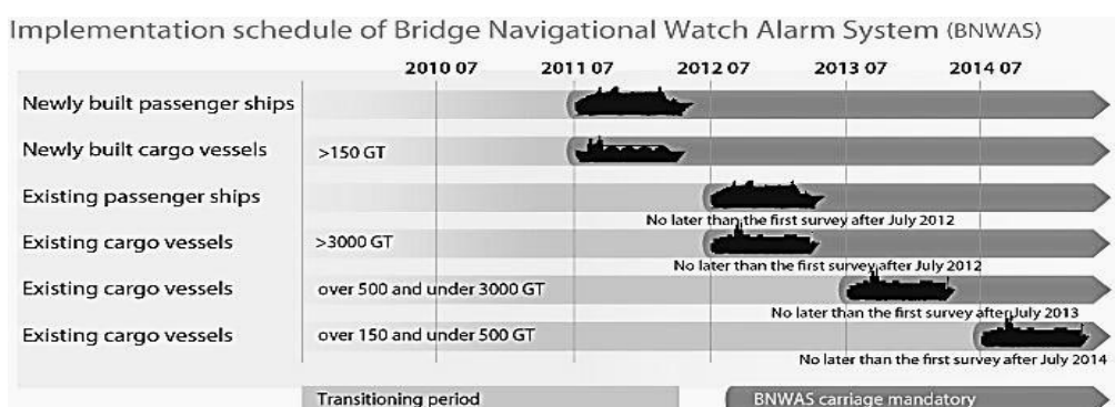
Slika 8: Implementacija BNWAS sustava (Oways Online, 2024).
