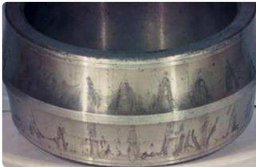
Slika 9. Korozija na ležaju uzrokovana vodom u mazivu [1]
