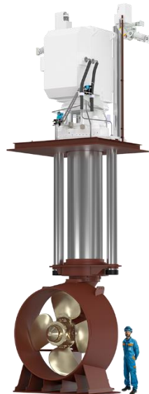
Slika 7. Uvlačivi azimutni porivnici [4]
