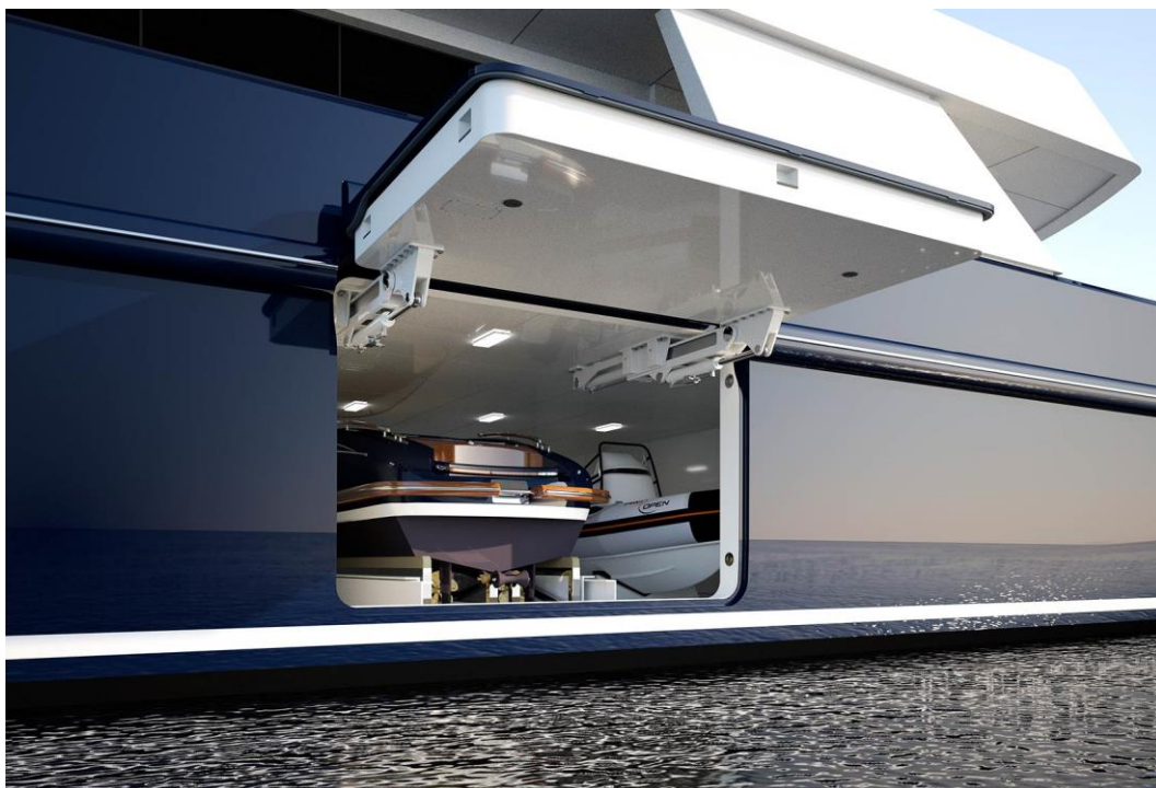
Slika 15. Primjer vodonepropusnih vrata na super jahti
