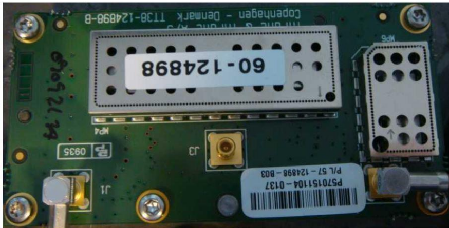
Slika 17. Duplekser/niskošumno pojačalo - DLNA
