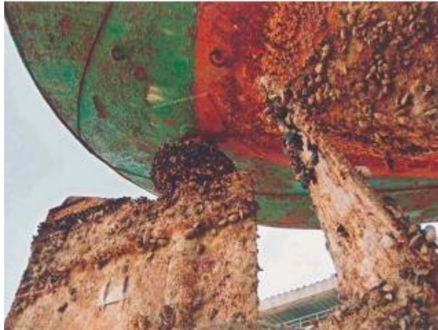
Slika 1. Obraštaj podvodnog dijela brodskog trupa
