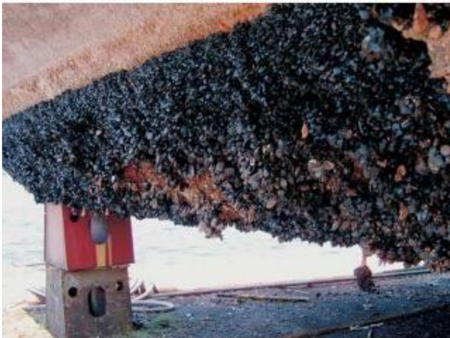
Slika 2. Obraslo dno plutajuće platforme
