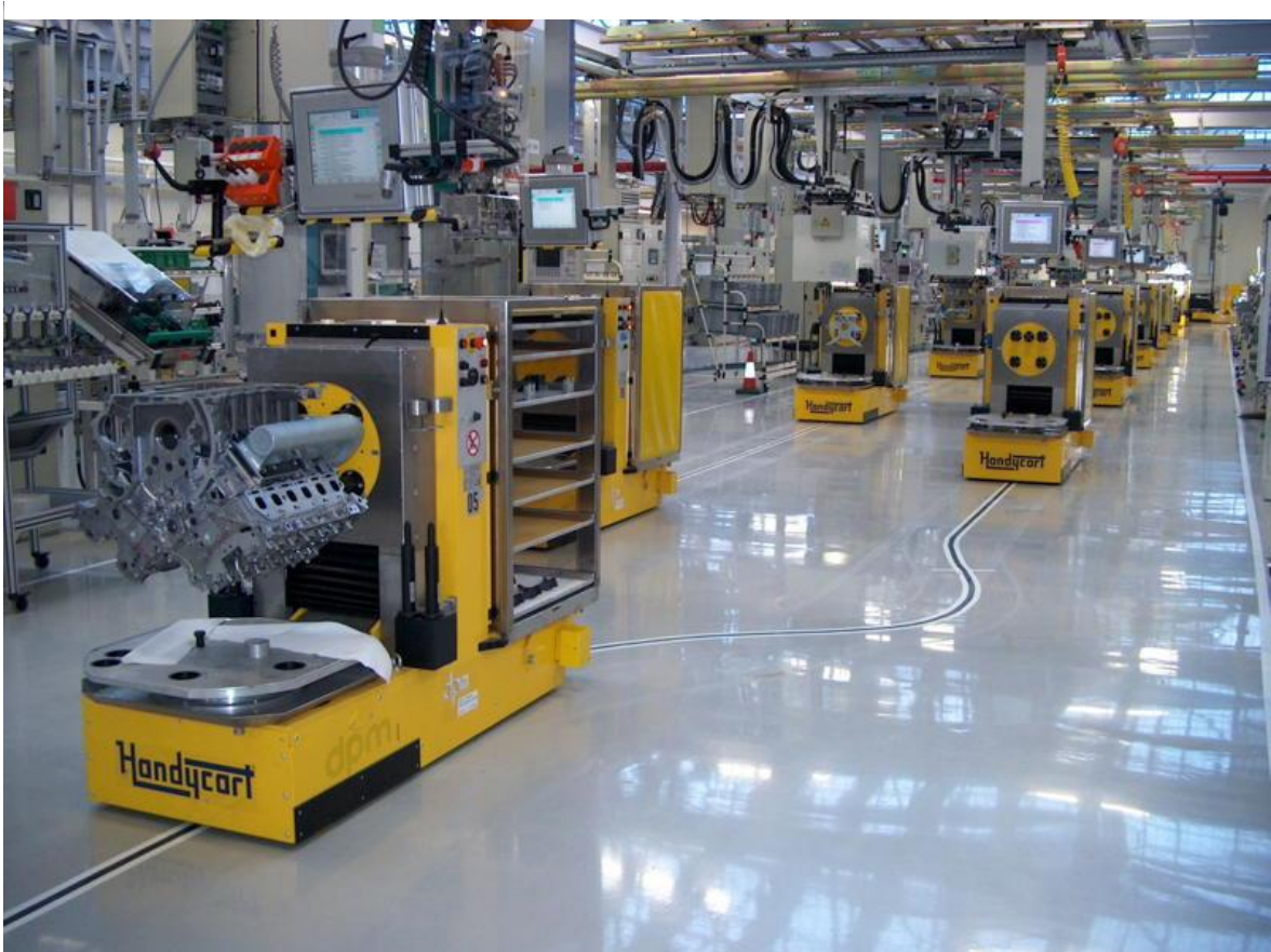
Slika 5. Prikaz optičkog načina navođenja vozila
