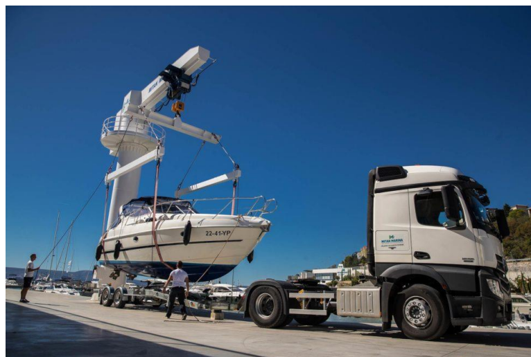
Slika 13 Fiksna stupna dizalica postavlja plovilo na prikolicu kamiona, Mitan marina, Novi Vinodolski
