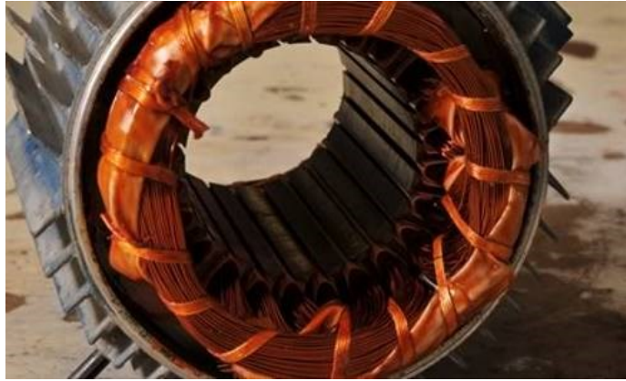
Slika 10. Stator elektromotora sa bakrenim žicama
