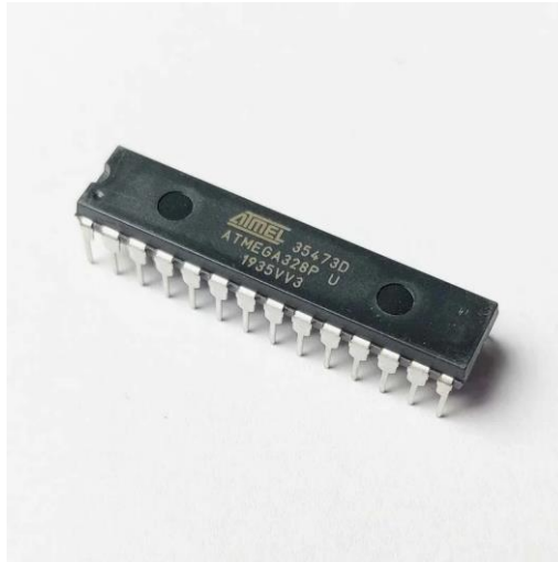
Slika 2. DIP izvedba ATmega328P mikroupravljača
