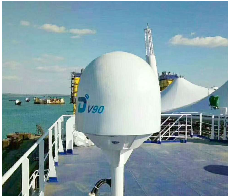
Slika 13: Parabolična antena unutar zaštitne kupole
