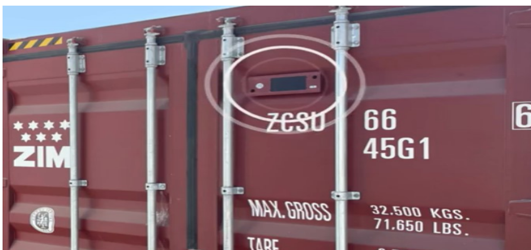
Slika 14. Solarni uređaj za praćenje kontejnera
