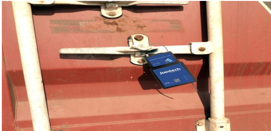
Slika 15. Jointech JT701GPS uređaj za praćenje u obliku plombe
