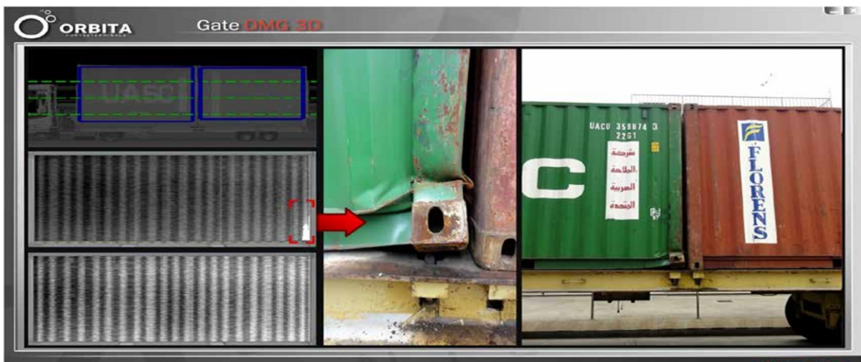
Slika 5. Automatska kontrola oštećenja
