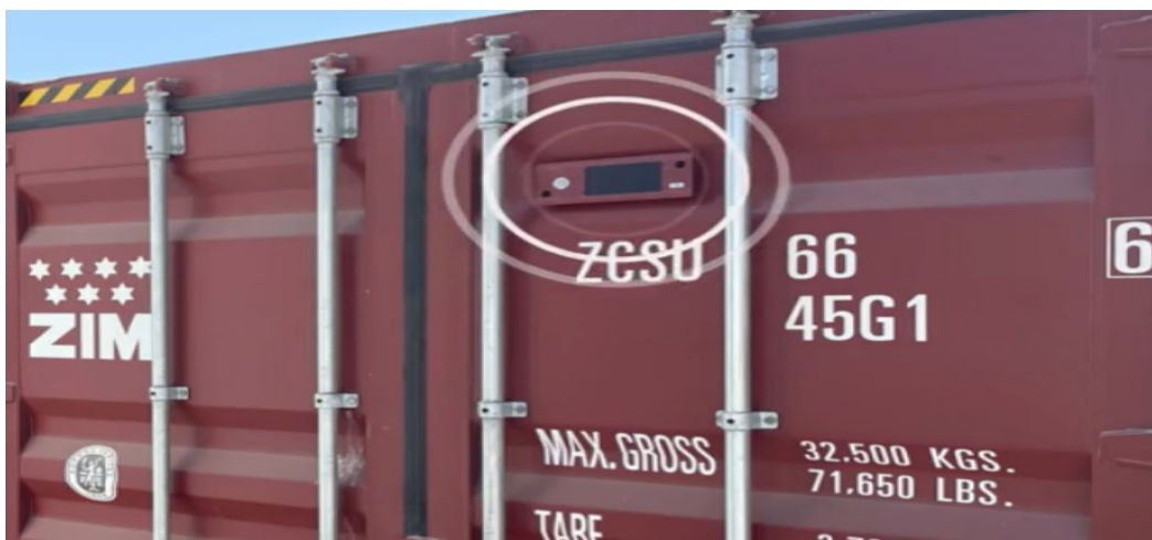
Slika 14. Solarni uređaj za praćenje kontejnera
