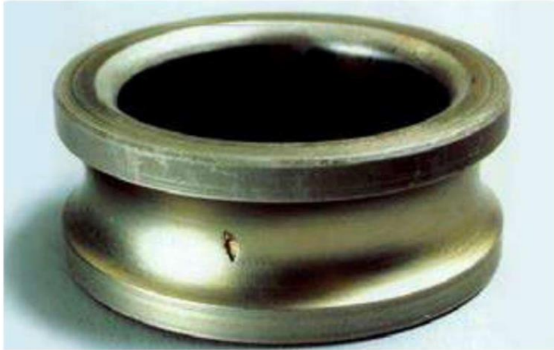
Slika 2. Pukotina u ležaju zbog zamora materijala
