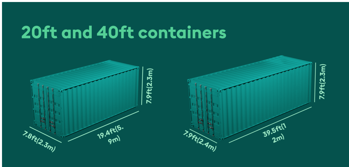
Slika 1: Usporedba 20 i 40 stopnog kontejnera
