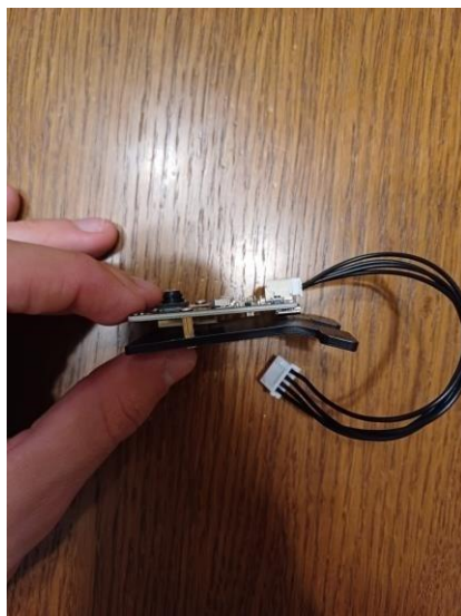
Slika 8. Pričvršćivanje modula kamere na montažni nosač
