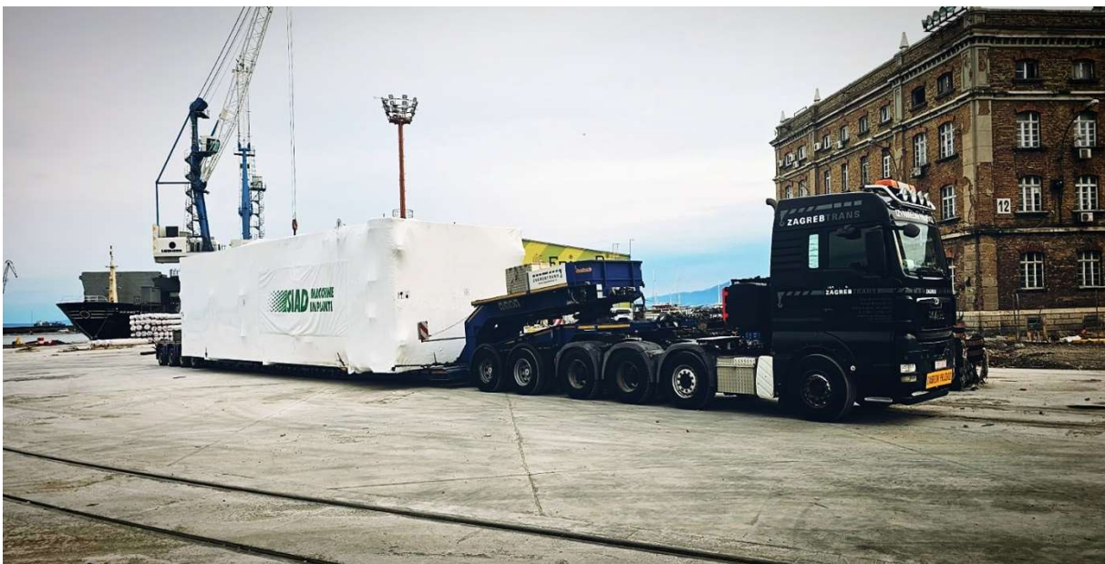
Slika 7. Transformator ukrcan na modularnoj kombiniranoj hidrauličnoj prikolici
