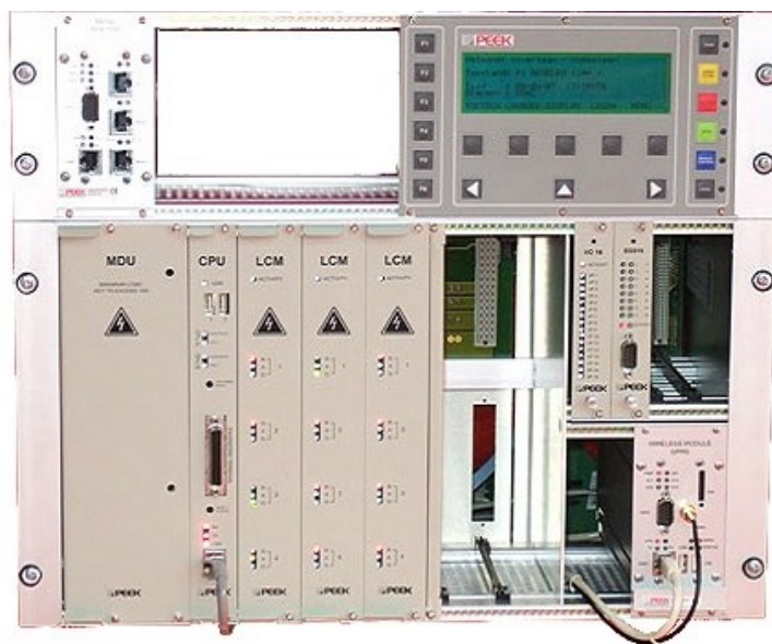
Prikaz 7. Eurocontroller EC-2 semaforska upravljačka jedinica
