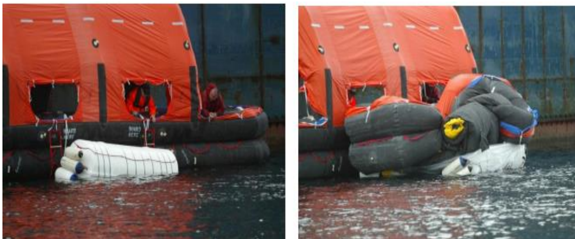
Slika 5 Napuhivanje dodatnih splavi za spašavanje
