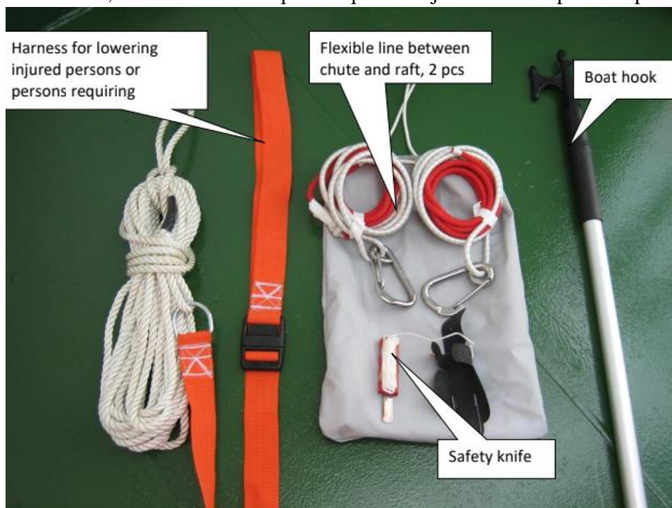
Slika 8 Pomoćna oprema sustava za brzo napuštanje broda
