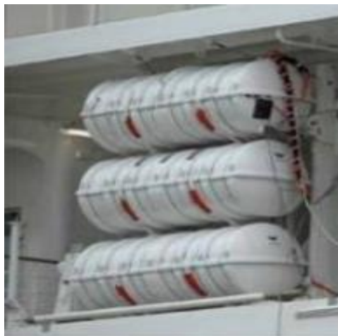
Slika 2 Spremnik splavi za spašavanje
