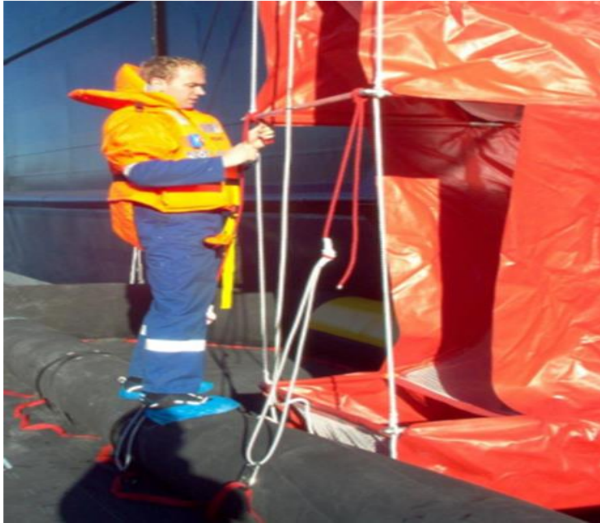
Slika 7 Vežanje i stabilizacija cijevi za evakuaciju
