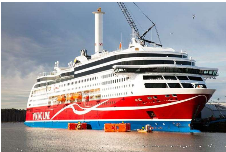
Slika 6. Instalacija Flettnerovog rotora na putnički brod Viking Grace
