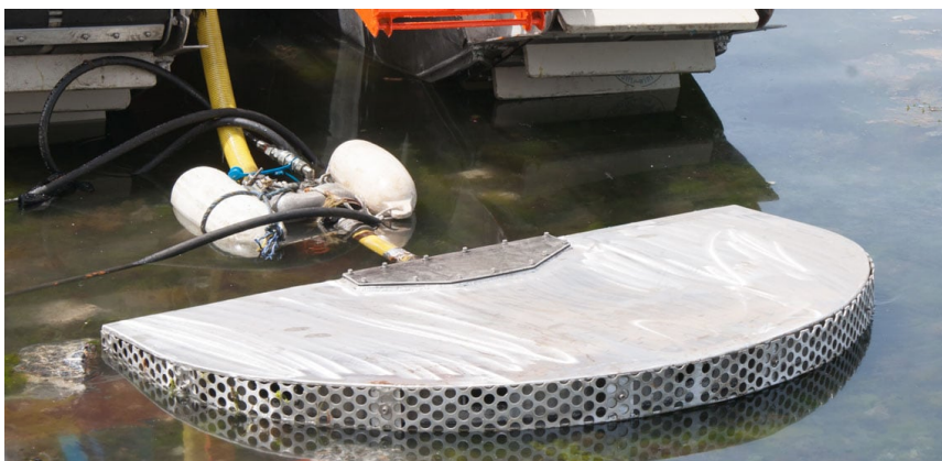
Slika 13. Vrsta skimera s usisnom granom
