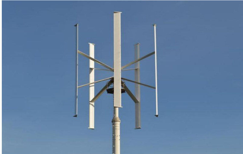
Slika 12. Vjetroturbine s vertikalnom osi rotora (VAWT)
